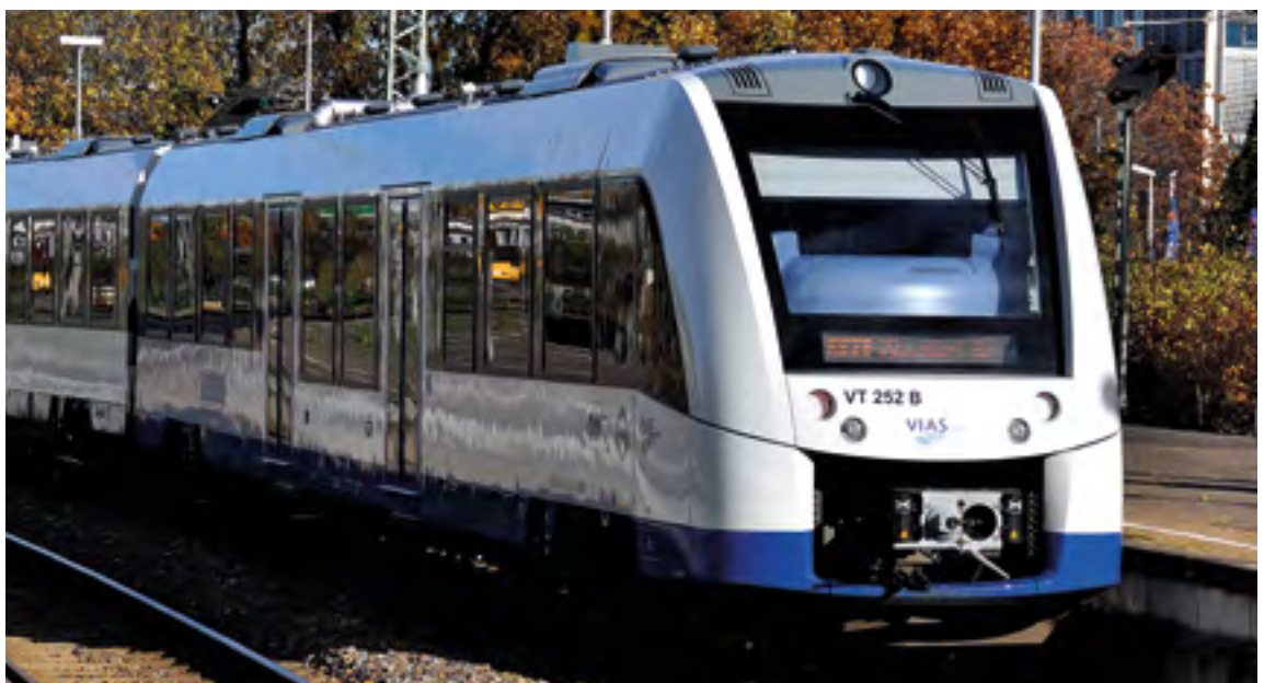
Im Erft-Schwalm-Netz betreibt VIAS Rail neue LINT-Dieseltriebfahrzeuge des Herstellers Alstom. Hier ein LINT 54 der RB 39 im Hauptbahnhof Neuss.
